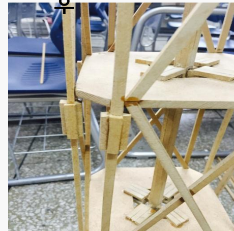
취약부분 보완 후
